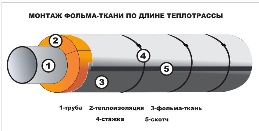
3. **Монтаж отрезками** – замеряется длина окружности трубы вместе с теплоизоляцией, после отрезаются отрезки с учетом нахлеста в 5см, монтируются на трубу с проклеиванием стыков скотчем. В качестве стяжки может использоваться – проволока, стальная лента, либо полимерная УФ-стойкая лента со скобами.
